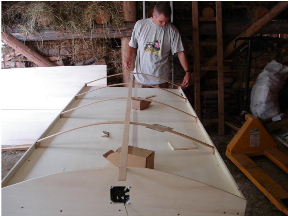
Fig 14 : Befestigen der Bogen
